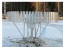
Outside OTT Pluvio 2
